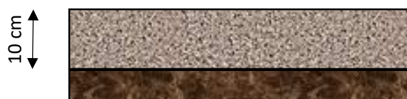
Coupe sur dallage non armé sur terre-plein relevé au droit du sondages S-10 et S-11 sur la zone C
