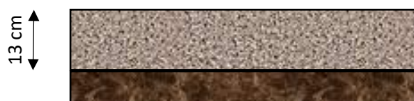
Coupe sur dallage non armé sur terre-plein relevé au droit du sondage S-1 sur la zone A
