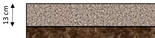
Coupe sur dallage non armé sur terre-plein relevé au droit du sondages S-4, S-5, S-6 et S-7 sur la zone B
