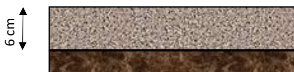
Coupe sur dallage non armé sur terre-plein relevé au droit du sondage S-12 sur la zone C
